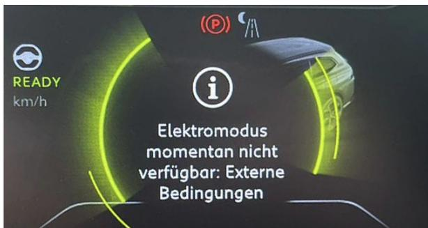
Abbildung 4: Automatische Deaktivierung des Elektromodus
