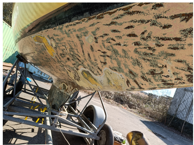
Abbildung 4: Manuelles Abtragen der Schichten am Rumpf einer Dehler Varianta.
