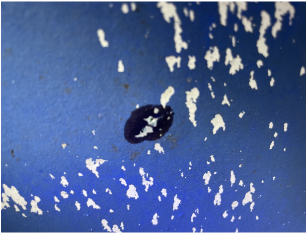
Abbildung 2: Austritt der Säure aus der Osmoseblase.
