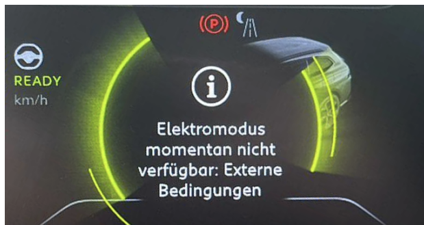
Abbildung 4: Automatische Deaktivierung des Elektromodus
