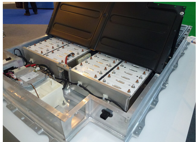
Abbildung 1: Lithium-Ionen Batteriepack eines VW ID3.
