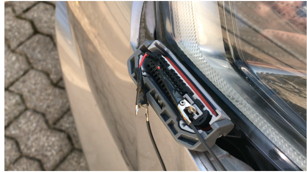
Abbildung 1: Angeklemmte PINs am Stecker der Scheinwerfer-ECU.
