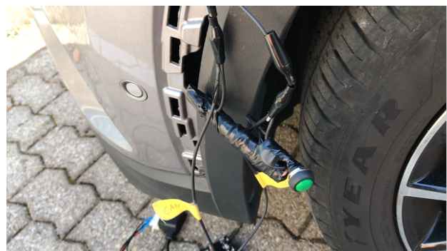
Abbildung 2: Der Tastendruck löst den Spannungsimpuls aus.
